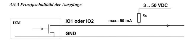
Die nachfolgende Tabelle enthält die Zuordnung von Spannungs- und Vorwiderstandsgrößen, die auf einen Strom, der bei Ausgängen üblicherweise 10 mA beträgt, bezogen ist. Dieser Widerstand ist nur dann notwendig, wenn der Zähler, auf den der Ausgang geschaltet wird, über einen passiven Eingang (ohne Stromversorgung) verfügt.
