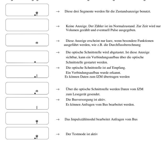
Neben der eigentlichen Zustandsanzeige wird in jedem Zustand durch das Sternsymbol angezeigt, ob zur Zeit Pulse empfangen werden. Wird ein Puls an einem der drei möglichen Pulseingänge erkannt, so wird das Sternsymbol für etwa 0.5 Sekunden aktiviert. Es ist also nicht erkennbar, wann ein Puls auftritt, wie lange der Puls andauert oder von welchem Eingang der Pulse empfangen wurden.
